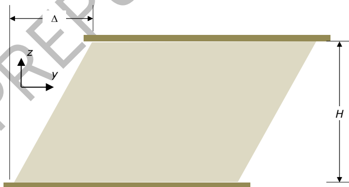
Figura 7-4. Deriva para el análisis estático de un tabique de albañilería en su plano
